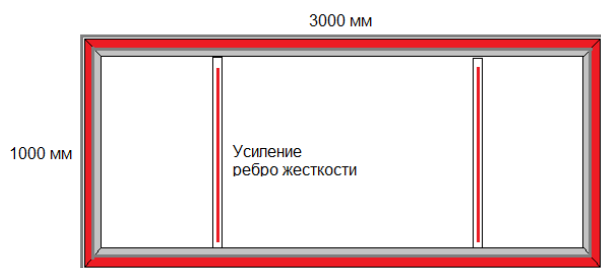
Модульная система НФВ ( рамка из профилей ) Клеевая система SANZ PANEL BOND
